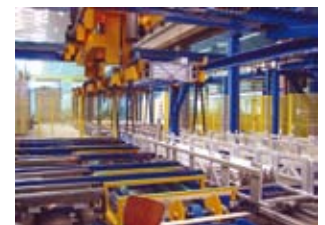
→ descarga automática de cestas
