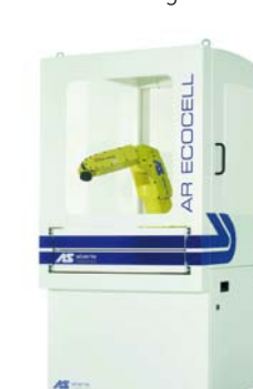
AR ECO-Cell: Entgraten und Prüfen
